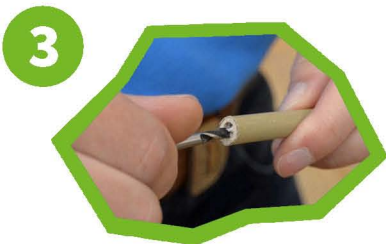
Mit den Bohrern eventuell vorhandene Tülle aus Bambusstangen entfernen
